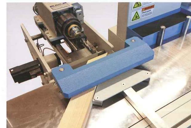
Frézování pokosových čepů a dlabů Milling of bevelled slots and tenons
