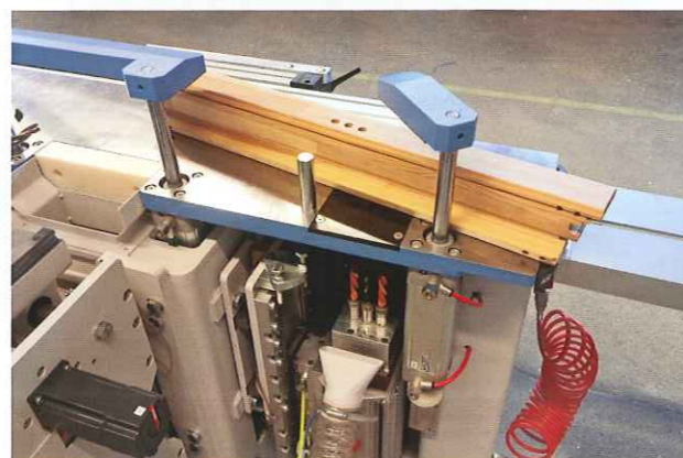
Spodní pracovní jednotka pro vrtání kliky a pantů Bottom drilling unit for handle and window hinges
