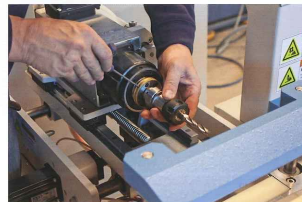
Pracovní jednotka s HSK 40A upínačem nástrojů Working unit with HSK 40A tool holder
