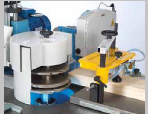
Tenonatura di due pezzi in una sola operazione
