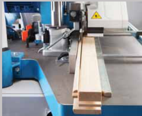
Durante la profilatura interna viene ricavato il listello fermavetro
