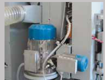
2) Posizionamento elettronico 2° albero principale (optional disponibile solo su Twin e Master). Permette l'utilizzo di utensili con diversi diametri di programmazione. Electronic positioning of the 2nd main spindle (available optional on Twin and Master only). It enables the use of tools with different working diameters.
