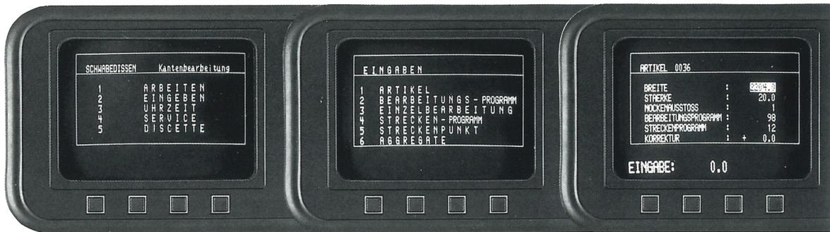
**DOPPELENDPROFILER-MENÜ-ÜBERSICHT** mit Bedienerführung durch die Bildschirmmasken. ■
