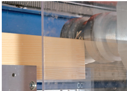
Freifahren und Bearbeitung der Stirnseite convoyage et usinage des faces frontales free travel and machining of the front face
