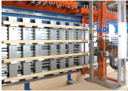
Auflegen der Kanteln dépose des barres de bois positioning of the scantlings
