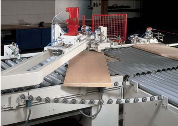
Drehvorrichtung kombiniert mit Kurbelschwinge und Konuskegel.
