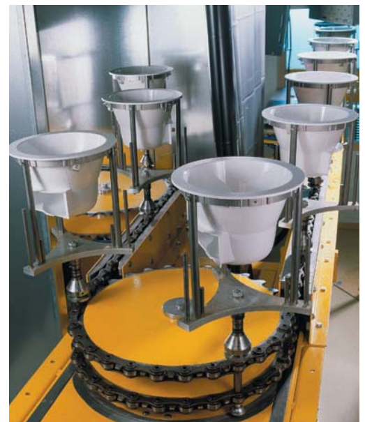
Spindelkettenförderer zum kontinuierlichen bzw. taktenden Transport der Werkstücke mit rotierenden Spindeln. Spindle chain conveyor for continuous (or cycled) transport of work pieces on rotating spindles.
