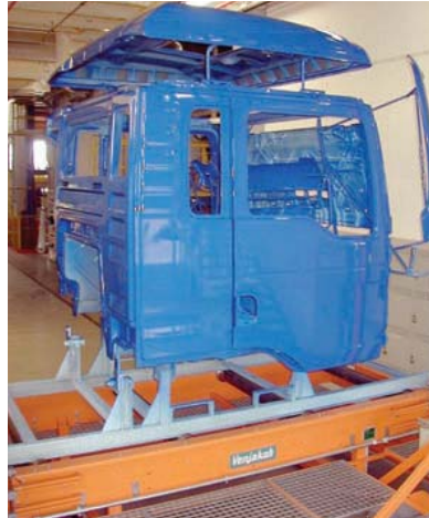
Skidförderer zum Transport von LKW-Führerhäusern durch Lackieranlage und Trocknung.
