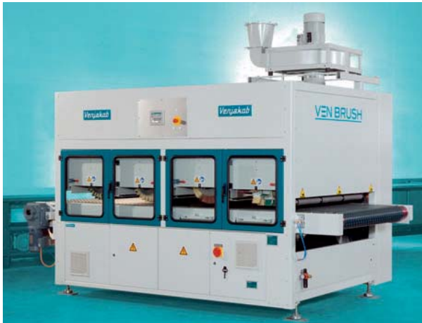
Profilflächenglättmaschine mit längs- und querschleifenden Bürsten.
