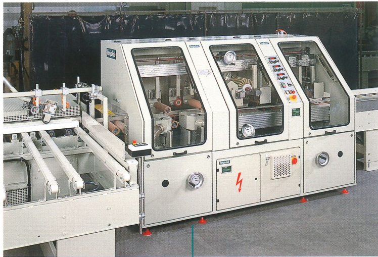
Profilleisten-Glättmaschine mit Einzugswinkelübergabe
