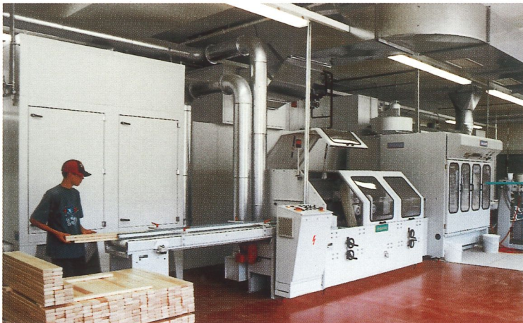
Lackieranlage für Leisten mit Glätten, Spritzen, Abstapelung und Trocknung
