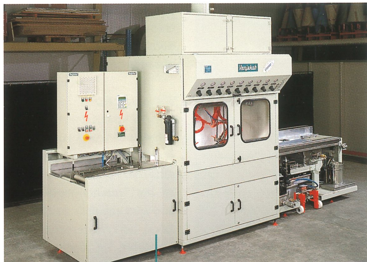
Leistenspritzmaschine Typ LT-coolac® mit Stahl- bandtransport
