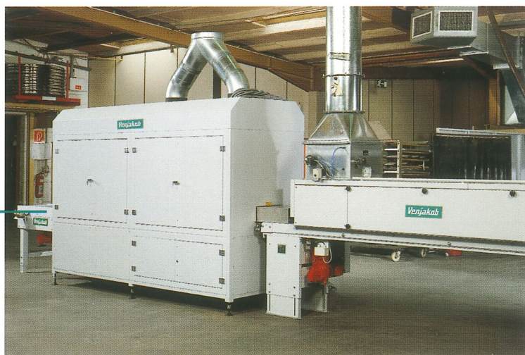
UV-Kanal mit vorgeschalteter Infrarot-Abluftzone
