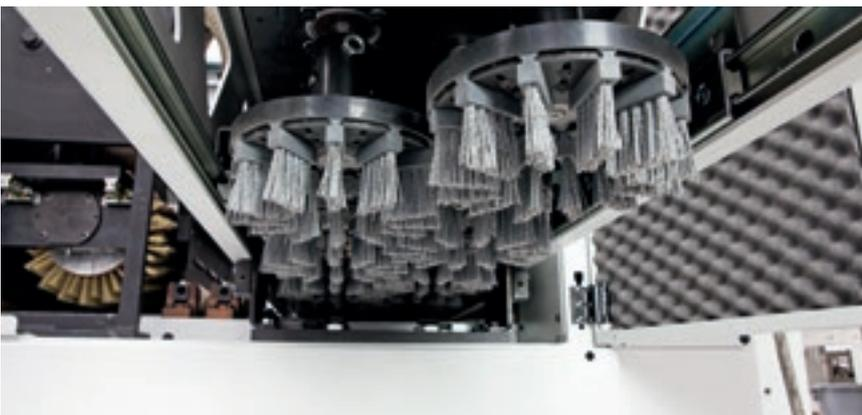
针对由不同木质制成的部件进行砂光加工，碟刷刷磨是理想的解决方案：软质材料从木纹上移除，同时可消除砂带振动产生的砂痕，确保了加工成品的卓越平滑度。碟刷
