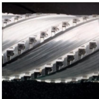
砂刨辊适用于木芯板的定厚加工, 并支持毫米级切削加工一次成型。
