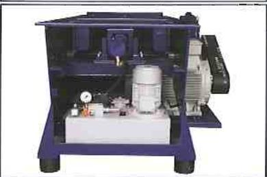
Das Hydraulikaggregat ist vollständig in den Maschinenkörper integriert. Der Hydraulikzylinder ist kardanisches gelagert.
