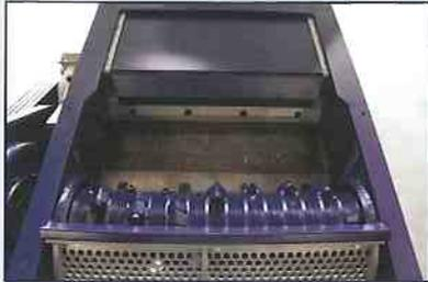
Über den serienmäßigen Andruckbalken wird das Material in die Rotorwelle gedrückt. Die optionale Abstreiferleiste verhindert, dass sich dünnes Material zwischen Schieber und Maschinentisch verklemt.
