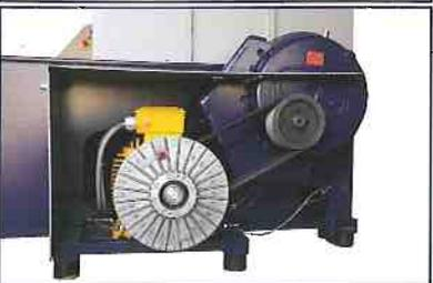
Durch die Turbokupplung wird ein Sanftanlauf erzielt und Kraftspitzen absorbiert.
