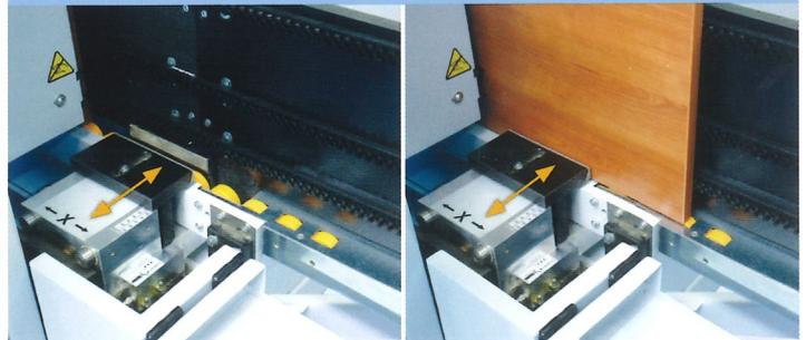
Einfaches Einstellen der Spannzange (manuell) auf Werkstückdicke (Spannzangenhub 10 mm). Bei Werkstückdickenunterschieden von bis zu 10 mm ist keine manuelle Einstellung der Spannzange notwendig.
