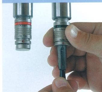
Bohrspindeln mit einer Drehzahl von 1500-7500 min<sup>-1</sup> mit patentiertem Schnellwechselsystem
