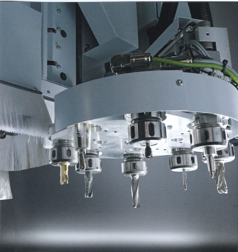
8-fach Werkzeugwechsler (mitfahrend in X-Y)
