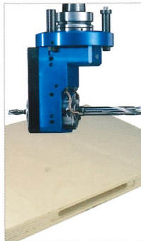
Schlosskasten, 2 Spindeln, Ø 16/20 mm
