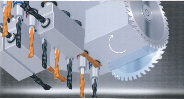
High-Speed Nutsäge (0° / 90°) – schwenkbar in X und Y
