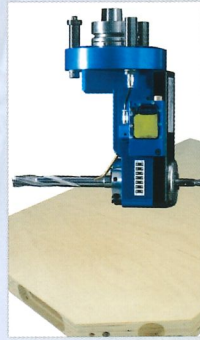
High Performance Schlosskasten, 2 Spindeln, Ø 16/20 mm
