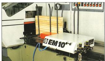
Este alimentador es apto para piezas de una longitud de 200 a 1200 mm, un ancho de 20 a 150 mm y una altura de 10 a 50 mm.
