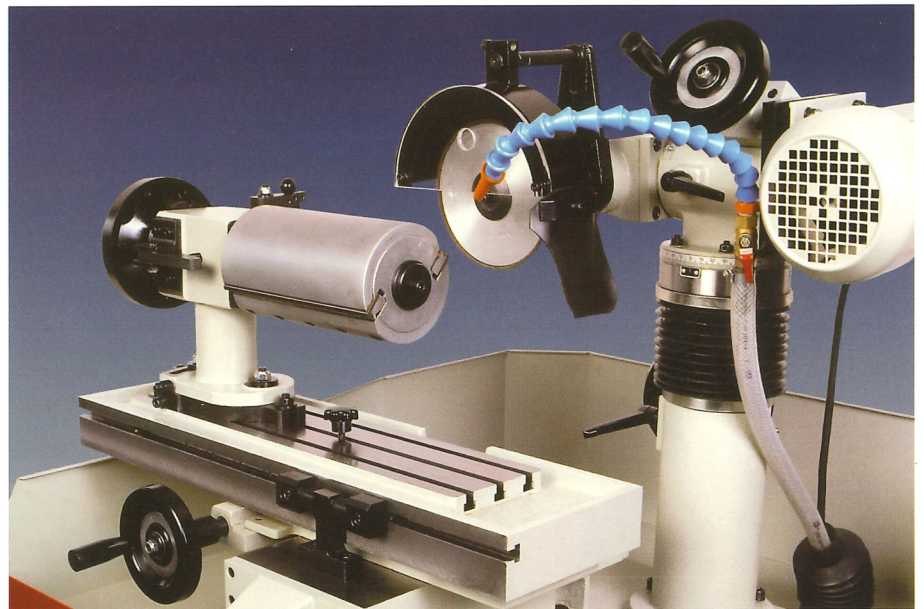
Afilado de cabezales porta-cuchillas de cepillado
