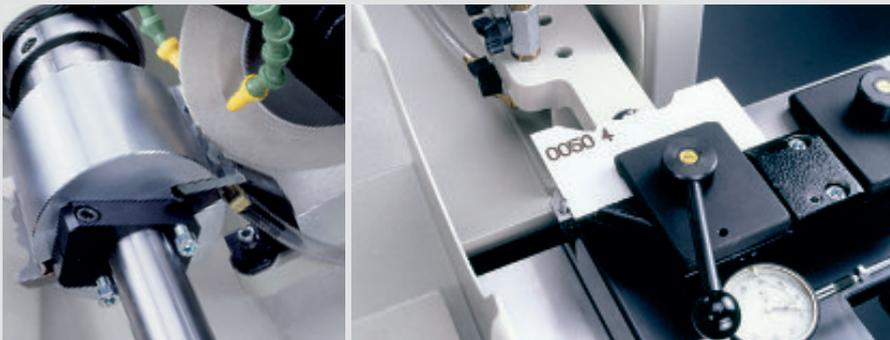
**Messerwerkzeuge** werden nach einer Profilschablone am Messerrücken profiliert und nachgeschärft. So werden absolute Profiltreue und optimale Schnittbedingungen für jede Fertigung und jeden Werkstoff sichergestellt. Scharfes Werkzeug, perfekt auf Rundlauf geschliffen!
