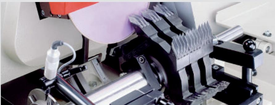
**Fräserwerkzeuge** werden an der Brust geschärft. Einzelnd oder als Fräsersatz – mit dem Rondamat erzielen Sie höchste Präzision. Fräserwerkzeuge werden für spezielle Fertigungen eingesetzt wie z.B. Rundstäbe, Nuten, Verleimprofile.
