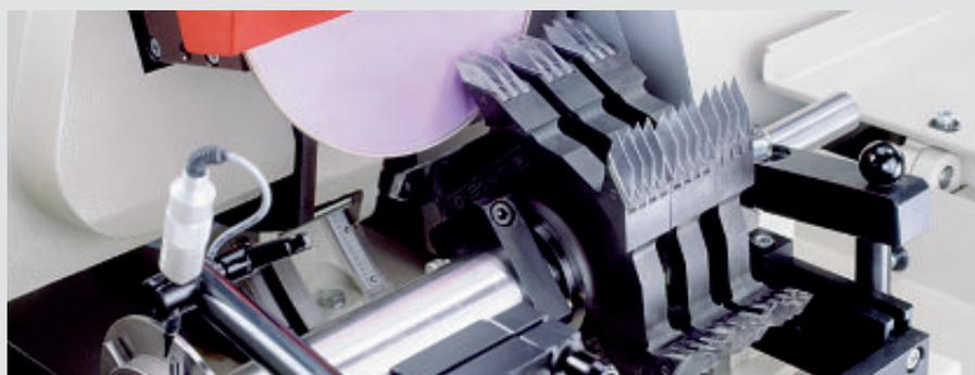
**Las fresas** se afilan en la parte frontal. Da igual si se trata de fresas individuales o juegos de fresas - con la Rondamat usted siempre obtendrá máxima precisión. Las fresas se emplean para fabricar productos especiales, tales como p. ej. palos redondos, ranuras, perfiles para encolar.
