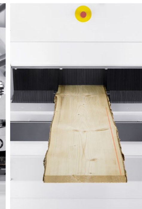
Laser pour visualiser le trait de scie: voir ce qui va être scié
