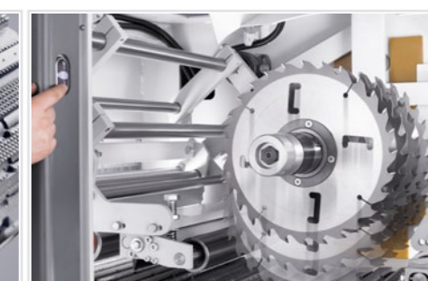
Réglage électrique en hauteur de l'arbre de scie: grand confort de manipulation
