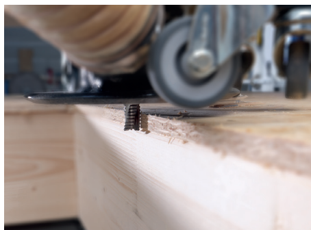
Faonnage des chants extérieurs
