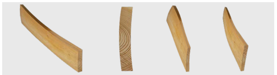
Bloki z wypaczeniem podłużnym lub poprzecznym, zagięte, powyginane
