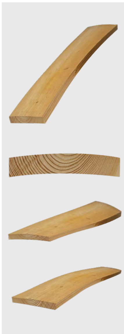
Bloki z wypaczeniem podłużnym lub poprzecznym, zagięte, powyginane
