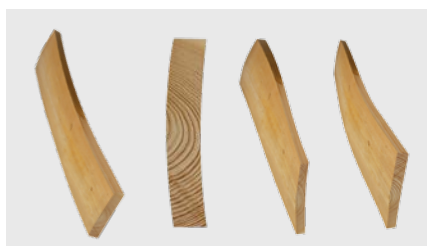
Bloques con alabeos longitudinales o transversales, deformaciones o curvaturas
