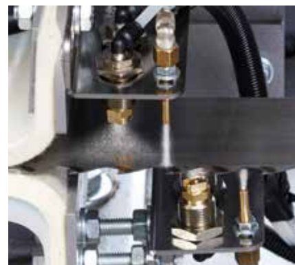
Sistema di spruzzatura per taglio legno umido
