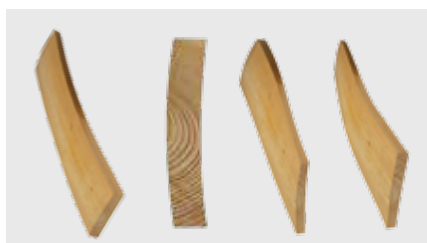
Blocchi con falcatura longitudinale o trasversale, curvatura o svergolamento
