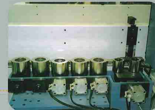
Zona de presión en Recercadora Pressure zone in Door-Casing Fitting Machine
