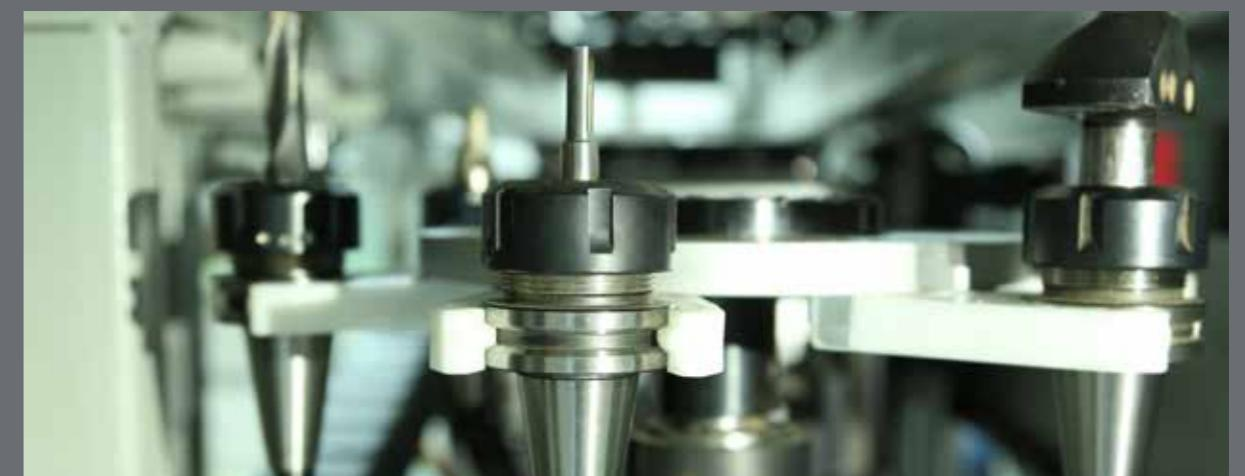
Opsiyonel olarak eklenen 6 takım kapasiteli otomatik takım değiştirme ünitesi freze uygulamalarında çok yönlü kullanıma imkan verir. Farklı takımlar hazır olarak bekletilir, takım değiştirme sırasında zaman kaybı minimuma iner.
