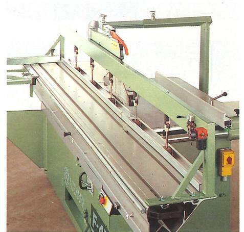
Druckbalken zum paketweisen Schneiden von Kunststoffplatten und Furnieren
