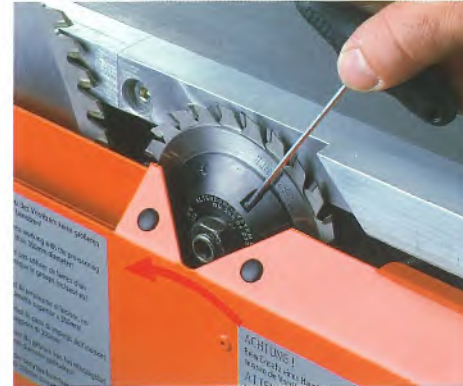
Klemmschraube per Schlüssel einfach lösen (linkes Foto). Das Einstellen der Schnittbreite erfolgt mit dem gleichen Schlüssel durch einfaches Drehen in +/-Richtung (rechtes Foto)
