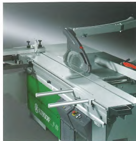
Zweite Auflage am Doppelrollwagen: vergrößerte Auflagefläche für breitere Werkstücke.
