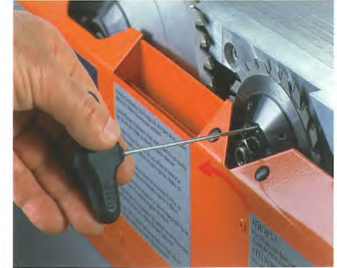
Klemmschraube per Schlüssel einfach lösen (linkes Foto). Das Einstellen der Schnittbreite erfolgt mit dem gleichen Schlüssel durch einfaches Drehen in +/-Richtung (rechtes Foto)
