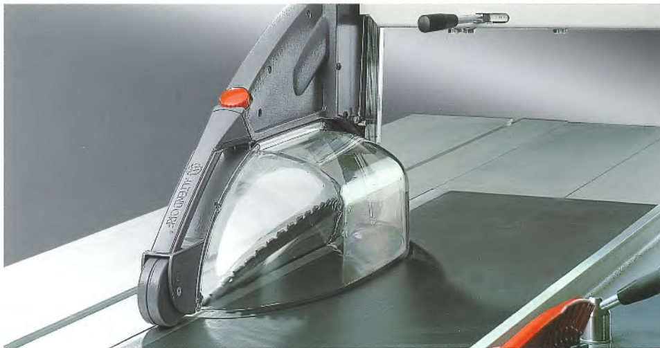
Die neue Schutzhaube erlaubt Sägeblattdurchmesser bis 500 mm. Der Wechsel schmale/breite Haube ist denkbar schnell und einfach über die Verriegelungsschraube (rot) durchgeführt
