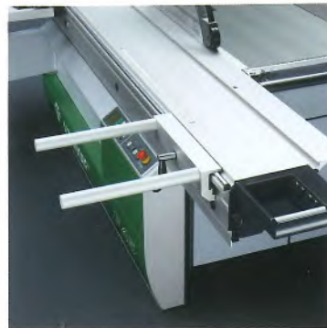
■ STEG – zweite Auflage am Doppelrollwagen: Vergrößerte Auflagefläche (Breite: 400 mm) für breitere Werkstücke.
