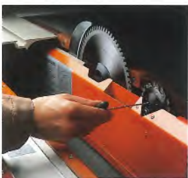
Das Einstellen der Schnittbreite erfolgt mit dem gleichen Schlüssel durch einfaches Drehen. Leichter geht's nicht!
