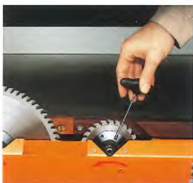
Klemmschraube per Schlüssel einfach lösen.
