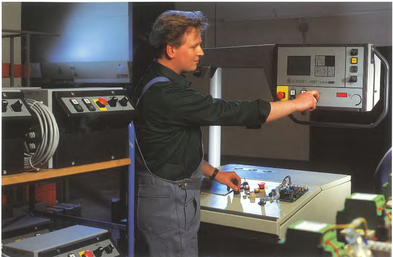
Funktions-Endkontrolle der elektronischen Baueinheiten.
