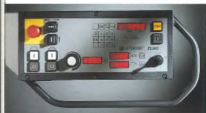
Drei Achsen in Augenhöhe unter Kontrolle. Hier mit Sonderausstattung VARIO-Antrieb und Vorritzer.
