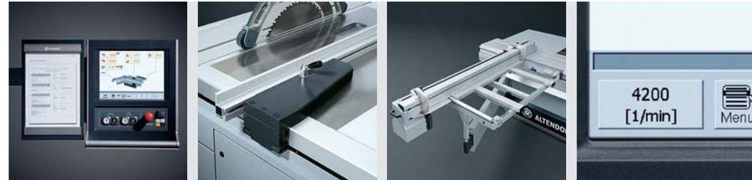
Die F 45 ELMO IV überzeugt mit höchstem Komfort: 12" Touchscreen zur Steuerung aller Vorgänge, elektromotorischer Parallelanschlag und Winkelanschlag, VARIO Antrieb zur stufenlosen Drehzahlregelung.
