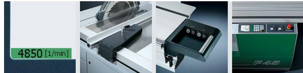
Diese F45 ist mit dem elektromotorischen Parallelanschlag, dem VARIO Antrieb sowie dem Ein-/Aus-Schalter am Doppelrollwagen ausgestattet.
