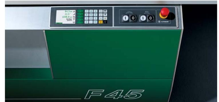
■ **Zur Sicherheit** verfügt die F 45 über eine Maschinendiagnose, die mögliche Störungen sofort und exakt im Bildschirm anzeigt. Über die USB-Schnittstelle können per USB-Stick Maschinen-Daten gespeichert werden. Ebenso ist ein Software-Update über diesen Weg problemlos und schnell möglich.
