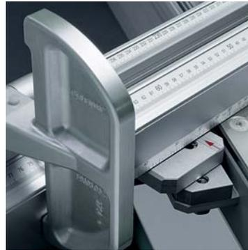
■ **Integrierter Längenausgleich (Grundausrüstung):** Beim Schneiden von Gehrungen kann der Anschlag durch den integrierten Längenausgleich sofort und ohne Umspannen stufenlos maßgenau eingestellt werden – ohne Verwendung zusätzlicher Einstelllehren für den Längenausgleich. Einfach das Anschlaglineal auf das gewählte Winkelmaß nach Skala verschieben und dann die gewünschte Länge an der Anschlagklappe einstellen.
