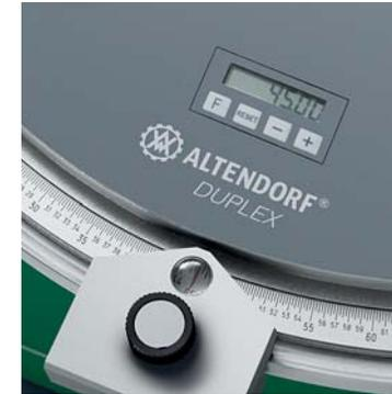
■ **DUPLEX D:** Die Funktionalität entspricht dem DUPLEX. Der DUPLEX D ist jedoch mit einer digitalen Winkelanzeige ausgestattet, die die Werte mit einer Genauigkeit auf 1/100° anzeigt.
