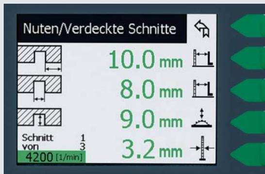
**Nutfunktion:** Nach Eingabe der Nutparameter erfolgt automatisch das schrittweise Positionieren des Parallelenschlags zur Fertigstellung der Nut.
