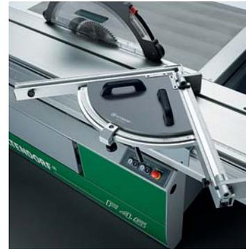
■ **Doppelseitiger Gehungsanschlag DUPLEX:** Die DUPLEX Anschläge erlauben Winkelschnitte von 0–90° sehr schnell, genau und stufenlos. Bei 45° kann die Gehung beidseitig am Werkstück ohne Verstellung der zwei Anschläge geschnitten werden. Die Maßeinstellung erfolgt über Lupe, Maßskala und Skala für den Längenausgleich. Alle DUPLEX Varianten sind problemlos auf der gesamten Wagenlänge positionierbar.
