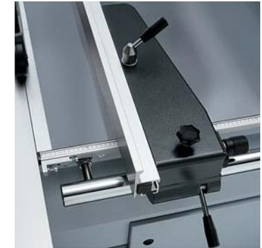
■ **Der Parallelanschlag mit manueller Feineinstellung:** Der Anschlag ist leicht zu verstellen und dank der Feineinstellung sehr präzise manuell zu justieren. Die Leichtgängigkeit erhält der Anschlag über das hart verchromte Rundstangensystem. Sollen große Platten aufgeteilt werden, kann der Anschlag mit einem Griff unter die Tischenebene geschwenkt werden. Mehr Seite 54.
