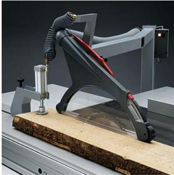
■ **Pneumatischer Schnellspanner:** Sichert die Auflage des Werkstücks auf dem Doppelrollwagen. Drahtlos per Funkfernbedienung gesteuert, erzeugt der Schnellspanner eine Spannkraft von max. 1 000 N. Das Werkstück liegt unverrückbar am Winkelanschlag an. Werkstücke bis max. 90 mm bzw. von 80–170 mm Dicke können gespannt werden. Mit einer oder zwei Spannvorrichtungen lieferbar.
