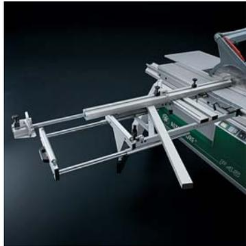
■ **Querschlitzenverbreiterung:** Ausziehbar bis 700 mm. Bei der F45 ELMO IV 650 mm, nicht ausziehbar.
