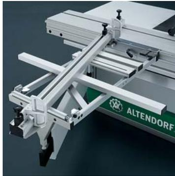
■ **Winkel-Gehrungsanschlag (Grundausrüstung):** Dieser Anschlag erleichtert das präzise Schneiden von Winkeln und Gehrungen in einer Funktion. Der Wechsel zwischen der vorderen und hinteren Position auf dem Querschlitzen erfolgt ohne Anheben des Anschlags. In beiden Positionen ist der Schwenkwinkel stufenlos um  $49^\circ$  verstellbar und wird über eine Maßskala angezeigt. Selbst bei geschwenktem Anschlag ist eine große Werkstückunterstützung vorhanden.
