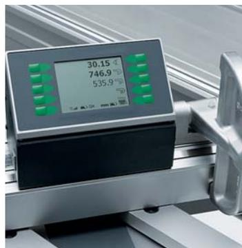
■ **PQS mit DIGIT LD:** Der DIGIT LD zeigt über die Funktion des DIGIT L hinaus zusätzlich den Schwenkwinkel im neuen LCD-Display digital an. Der Schwenkwinkel kann auf 1/100° genau eingestellt werden. Bei der Anzeige der Längenmaße wird der Längenausgleich direkt eingerechnet.
