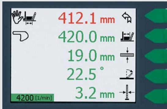
Die **Spitzmaßfunktion** ermöglicht es, Werkstücke ein- oder beidseitig mit Winkelschnitt zu formatieren. Unter Berücksichtigung der Werkstückdicke und des Schwenkwinkels wird das einzustellende Maß für den Winkelschlag angezeigt.
