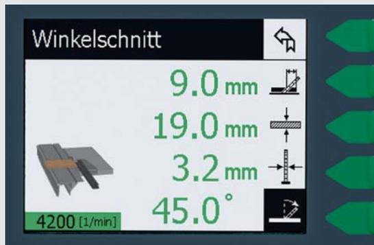
Mithilfe der **Winkelschnittfunktion** wird unter Berücksichtigung des Schwenkwinkels das gewünschte Fertigmaß erzeugt. Zuvor werden in der Eingabemaske die zusätzlichen Parameter Werkstückdicke, Schnittfugenbreite und Übermaß eingegeben.
