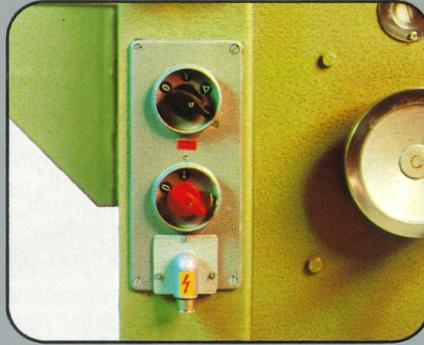
Schalterkombination nach den neuesten VDE-Vorschriften bestehend aus abschließbarem Hauptschalter, Stern-Dreieck-Schalter, Motorschutzschalter und Unterspannungsauslöser.
