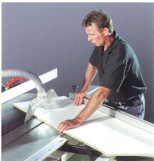
**Распиливание под углом:** Односторонний упор для запиловки под углом в диапазоне 30–135 градусов расположен за двухроликовой кареткой (с позиции оператора). При обработке крупномерных заготовок с использованием поперечных салазок угловой упор можно демонтировать.
