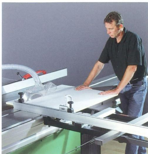
**3-я операция:** Перед отпиливанием последнего отрезка нужно откидной ограничитель углового упора настроить на тот же размер, что выставлен на параллельном упоре. После этого заготовка поворачивается так, чтобы она уже обрезанной прямой кромкой прилежала к откидному ограничителю.
