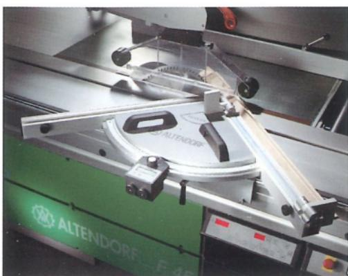
**DUPLEX D:** Двухсторонний упор для пиления под углом, цифровая индикация угла при настройке.
