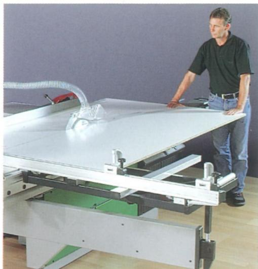
**1-я операция:** Плита кладётся с прилеганием к угловому упору. Параллельный упор настраивается на требуемую ширину. Плита распиливается на параллельные полосы, при этом она должна оставаться прижатой к угловому упору и лежать на легкоходовой каретке. Когда размер заготовки будет уже не достаточным для использования углового
