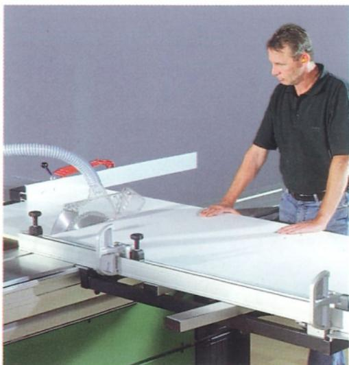
**2-я операция:** Полученные полосы расторцовываются на нужные длины. Для этого на параллельном упоре выставляется размер обработки и заготовка прижимается к угловому упору – таким образом обеспечивается пропил точно под прямым углом. Чтобы избежать перекоса заготовки в зоне между пильным диском и упором, нужно алюминиевый профиль параллельного упора перед пильным диском оттянуть назад.
