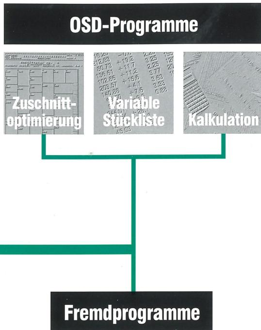
Um die Produktivität an der Formatkreissäge weiter zu steigern, wurde eine Schnittstelle zum marktführenden Schreiner- und Tischler-Branchenprogramm von OSD geschaffen. Bereits erfaßte Stücklisten können nach Projekt und Material selektiert und zur Schnittfolgenermittlung übergeben werden. Eine Datenübernahme über eine offene Schnittstelle ist ebenfalls integriert.
