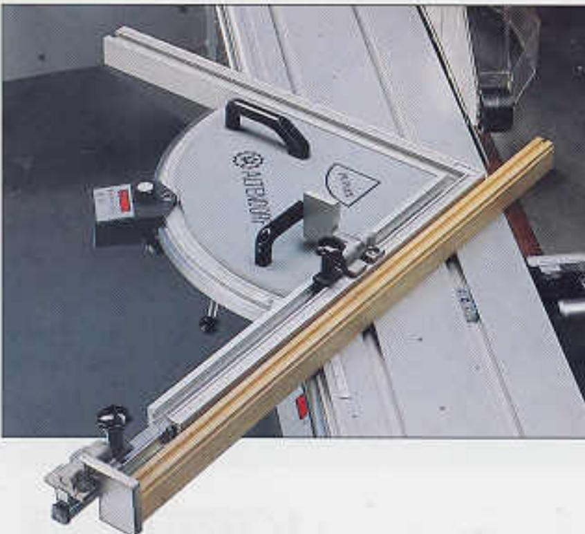
◀ Der doppelseitige Gehrungsanschlag mit digitaler Gradanzeige und Feineinstellung (DUPLEX D) erleichtert das Einstellen von  $0^{\circ}$ – $90^{\circ}$ . Das berührungslose Meßsystem arbeitet mit einer Genauigkeit von  $\pm 0,02^{\circ}$ . Man spart Zeit und arbeitet selbst bei komplizierteren Schnitten genauer.
