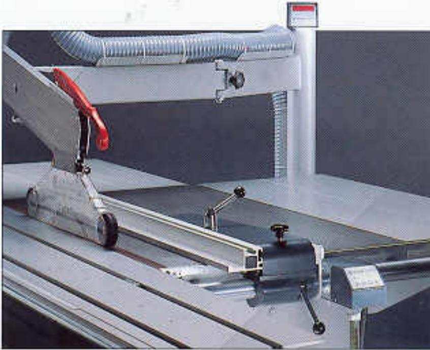
◀ Die digitale Maßanzeige am Parallelanschlag (DIGIT X) ist ein berührungsloses Meßsystem, das verschleißfrei und staubunempfindlich arbeitet. Gut ablesbare Leuchtziffern erleichtern das Ablesen. Genauigkeit:  $\pm 0,1$  mm.
