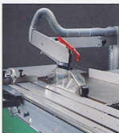
◀ Bei den Typen F90 und TKR90 findet die schmale Haube ihren Einsatz ebenso wie bei den Typen F45 und TKR45 in der  $0^\circ$ -Position. Die breite Schutzhaube ist bei den Typen F45 und TKR45 bei geschwenktem Sägeaggregat erforderlich.
