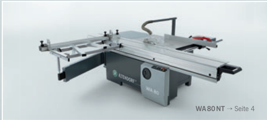
Altendorf WA 80 NT mit manueller Höhenverstellung des Hauptsägeblatts, nicht schwenkbar.
