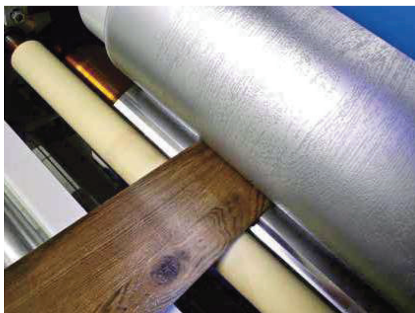
Rodillo de presión grabado. Engraved pressure roller.
