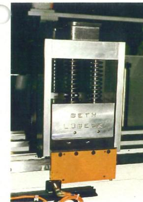
Die Linearführungen sind für eine Traglast von je 5,2 Tonnen ausgelegt und mit Führungswagen und Linearantrieb ausgerüstet. Dadurch wird eine extrem lange Lebensdauer ohne aufwendige Wartung erreicht.
