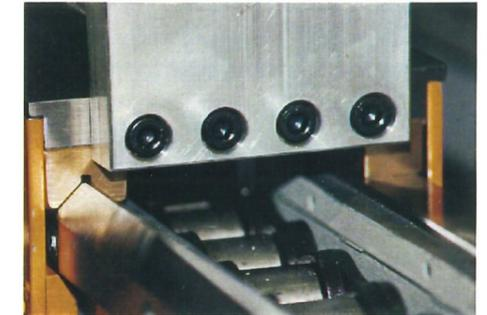
Der Direktantrieb der Fräswerkzeuge wird durch einen frequenzgeregelten Drehstrommotor mit einer Leistung bis zu 15 kW mit speziellen Spindellagerungen, die komplett gekapselt und auf Lebensdauer geschmiert sind, erreicht.
