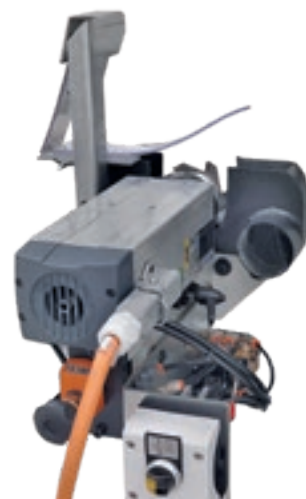
Le Groupe de fraisage permet de réaliser le rainurage et le fraisage sur la surface inférieure du panneau.
