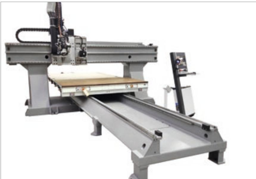
Excel puede configurarse en diferentes versiones, con superficie de barras **EPS**, con superficie continua **FT** o con superficie de **aluminio**.
