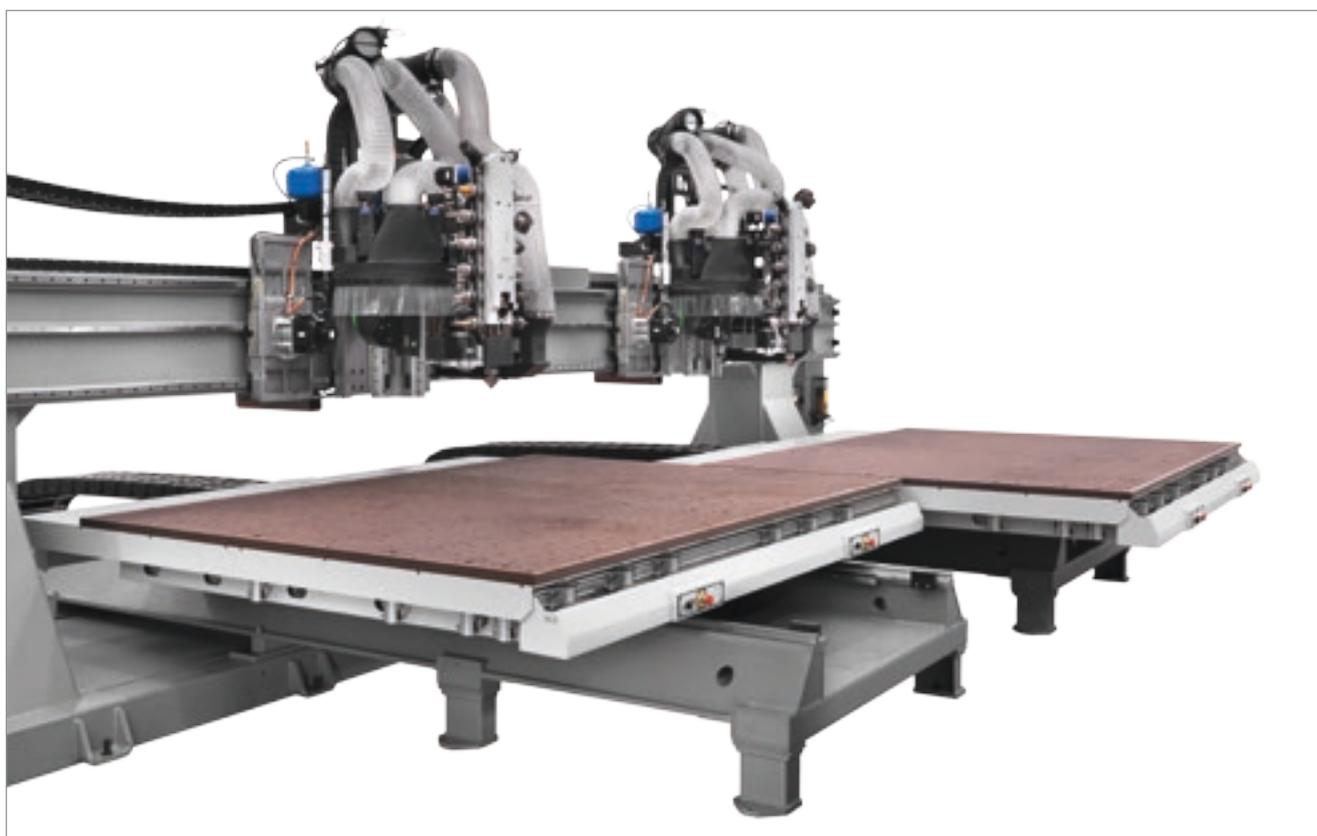
En los mecanizados de tableros de gran tamaño las dos superficies puede alinearse y trabajar en modalidad gantry sobre una superficie única.
