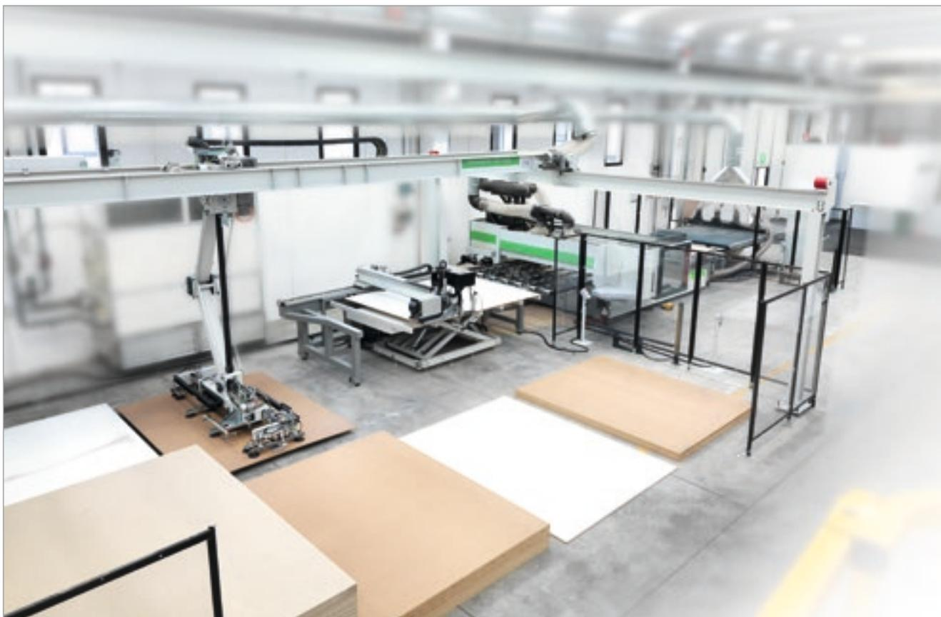
Excel puede integrarse perfectamente en la celda con Winstore, almacén automático para la gestión optimizada de tableros, y en la celda con sistemas de carga robotizados.
