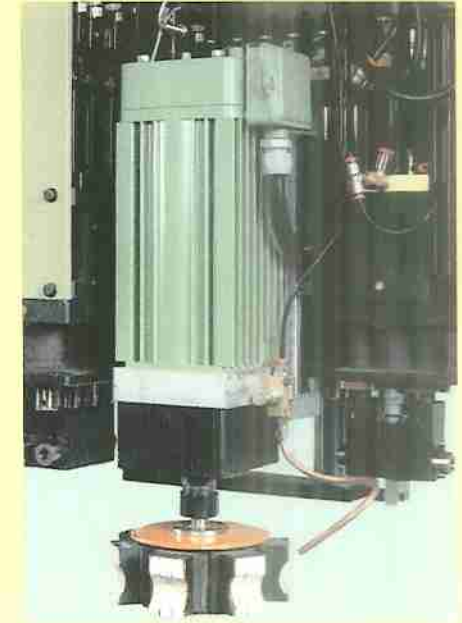
Ø 160 mm grooving unit rotating by N.C. 90° to make grooves in X e Y directions / Nutsägeeinheit Durchm. 160, 90° drehbar fuer Durchführung von Nuten, Richtung X und Y
