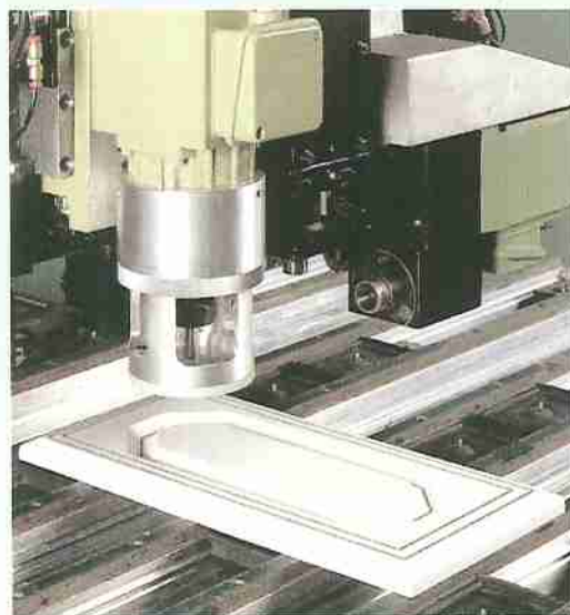
Router equipped with mechanical copier Fingerfraeser mit mechanischem Kopierer
