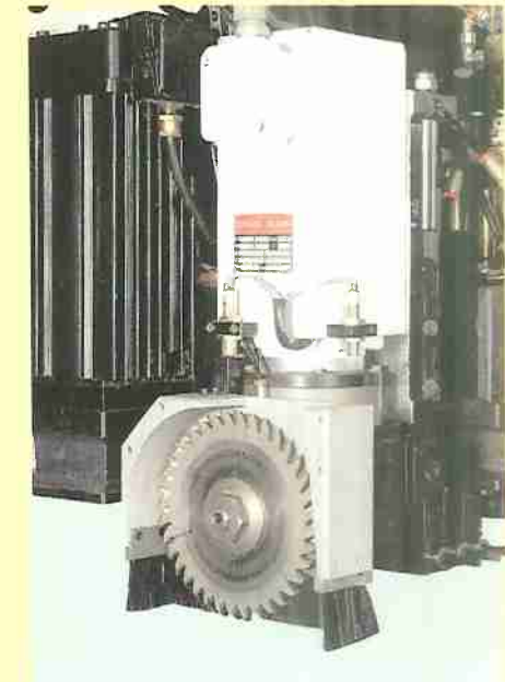
Ø 160 mm grooving unit rotating by N.C. 90° to make grooves in X e Y directions / Nutsägeeinheit Durchm. 160, 90° drehbar fuer Durchführung von Nuten, Richtung X und Y
