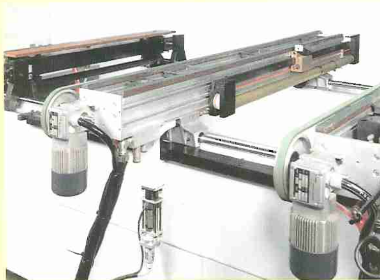
N.C. positioning of the panel supports NC gesteuerte Ausrichtung der Werkstueckanflagen
