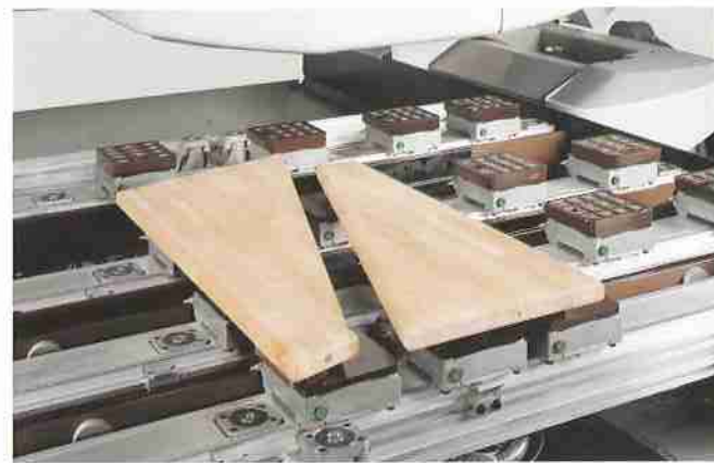
Lavorazione del gradino Bearbeitung der Stufe
