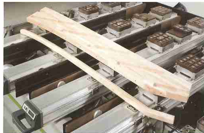
Lavorazione del montante laterale e del corrimano Bearbeitung der seitlichen Treppenwange und Handlauf
