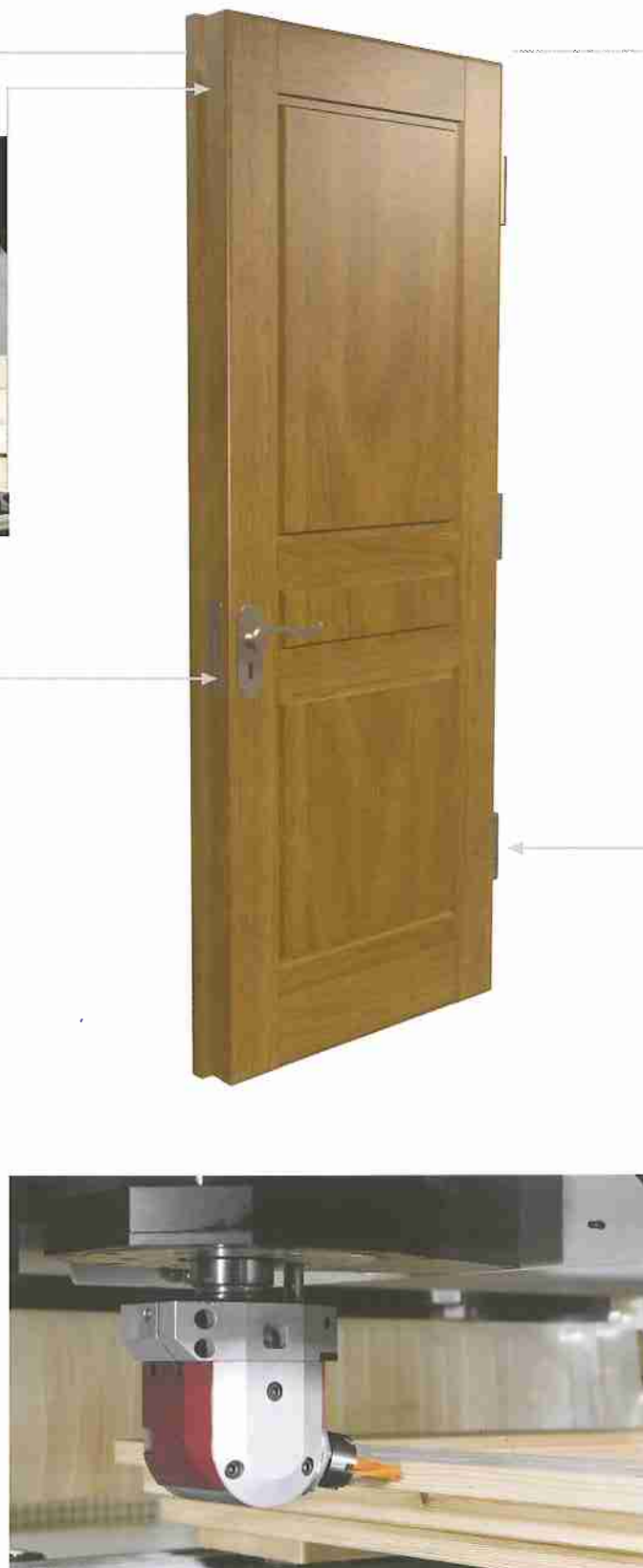
Foratura inclinata per anube. Bohren für Anuba-Bänder
