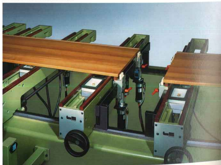
■ Piano di lavoro con ventose a depressione per il bloccaggio del pannello, con battute centrali ad esclusione automatica. ■ Werkstückauflage mit Saugnäpfen für Werkstückklemmung, mit automatisch ausschaltbaren Zentralanschlägen. ■ Panel support with vacuum pads for the clamping of the panel central, stops with automatic switching off. ■ Plan de travail avec ventouses à dépression pour le blocage du panneau avec butées centrales à exclusion automatique.
