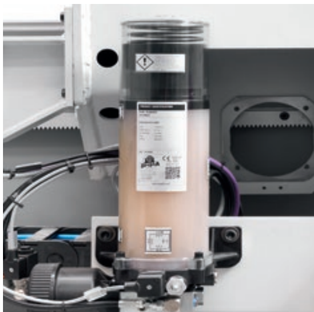
Lubricación automática cabezal de taladro BH29 2L.
