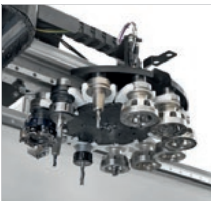
Almacén revólver de 12 posiciones en el cabezal y 16 posiciones a bordo del carro X.
