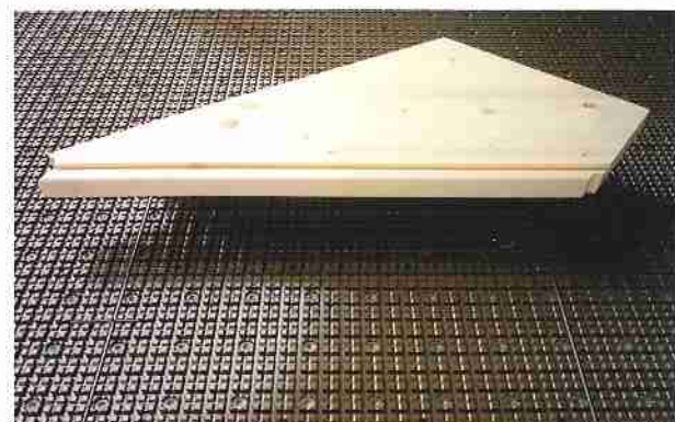
Lavorazione di elementi di scale. Machining of stair elements.
