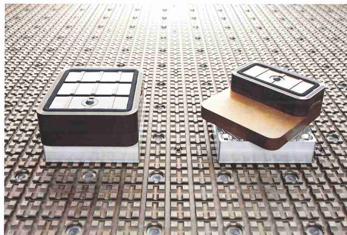
Moduli vacuum liberamente posizionabili sul piano di lavoro tradizionale senza l'ausilio di connessioni dedicate.
