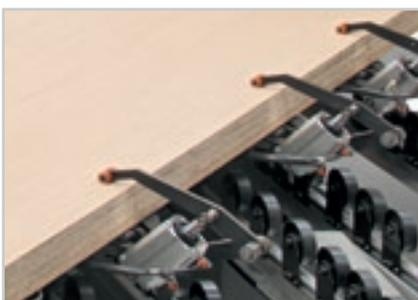
Los dispositivos de bloqueo de los tableros evitan que el paquete se suelte durante la rotación.
