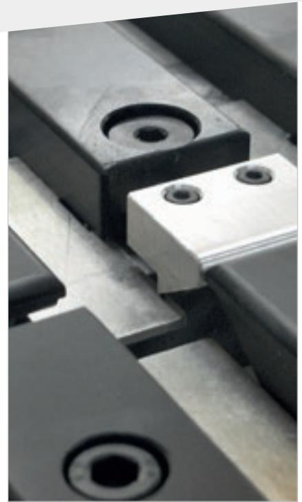
Sistema de cierre de la línea de corte para evitar la caída de recortes longitudinales.
