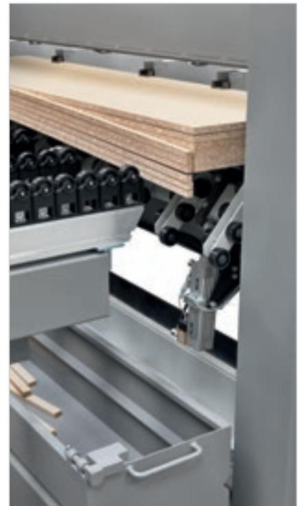
Los recortes longitudinales se evacúan a través de una trampilla totalmente automática compuesta por ruedas libres.
