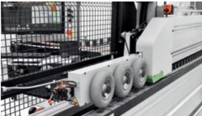
Les **roues de première passe** pour l'alignement parfait du chant longitudinal du panneau à travers la pression constante des 3 roues en caoutchouc.
