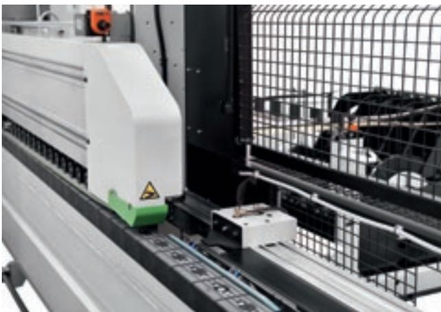
Le **dispositif de centrage** permet de centrer le panneau pour l'usinage du chant transversal.
