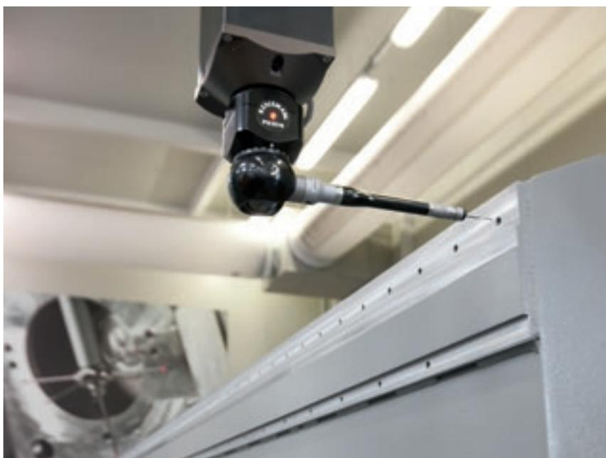
Chaque bâti respecte une tolérance de 2 centièmes de millimètre par mètre linéaire. De cette façon, en plus d'assurer la qualité de la charpente, cette solution permet d'éviter les opérations de remise en état pendant la phase d'assemblage qui ralentiraient inévitablement la livraison de la machine.
