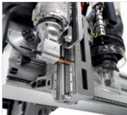
Elektrospindel mit 19,2 kW. Sägeaggregat D300. Aggregat 3+1.
