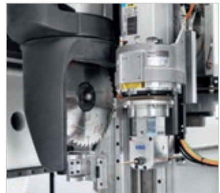
Elektrospindel mit 19,2 kW. FlexyWood PLUS. Aggregat 3+1.
