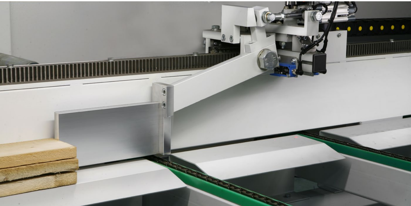
^ Carrello spintore con pinza pneumatica sotto-sopra
