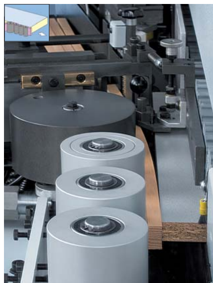
Druckzone Schwere Druckzone (bis 15 mm) für eine optimale Leimfugenqualität.
