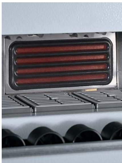
Heizstrahler Hochfeste Verklebung durch eine optimale Werkstückvorwärmung.
