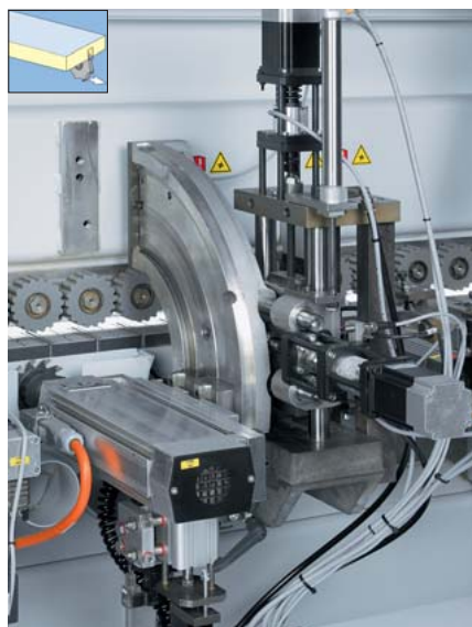
Schwenkbare Nutfräsaggregat Zum Nuten der Werkstückunterseite und der Stirnseiten. Zur Produktion von durchgehenden, nicht durchgehenden und unterbrochenen Nuten.
