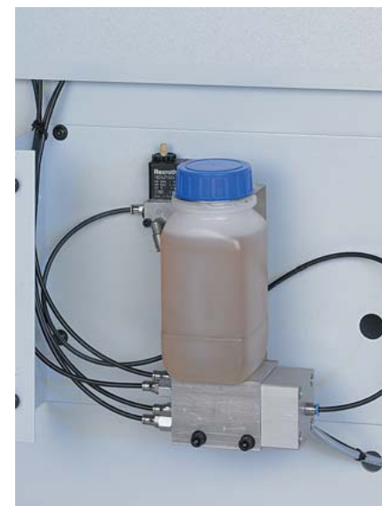
Zentral-Schmiereinheit Vollautomatische Schmierung der Kettenbahnführung für einen langlebigen und präzisen Lauf der Transportkette.
