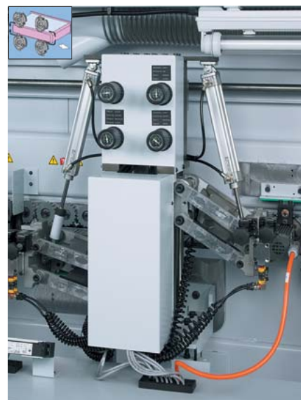
Formfräsaggregat Zum Eckenrunden von Dick-PVC-Kanten sowie Kopfanten an Post- und Sofformingteilen. Ausgerüstet mit automatischer Verstellung zwischen Dünn- und Dickkante. Werkstückdicke 60 mm.
