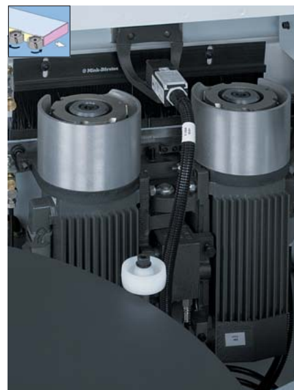
Fügefräsaggregat Perfekter Schnitt und hohe Standzeit durch Diamantwerkzeuge für eine optimale Leimfugenqualität.
