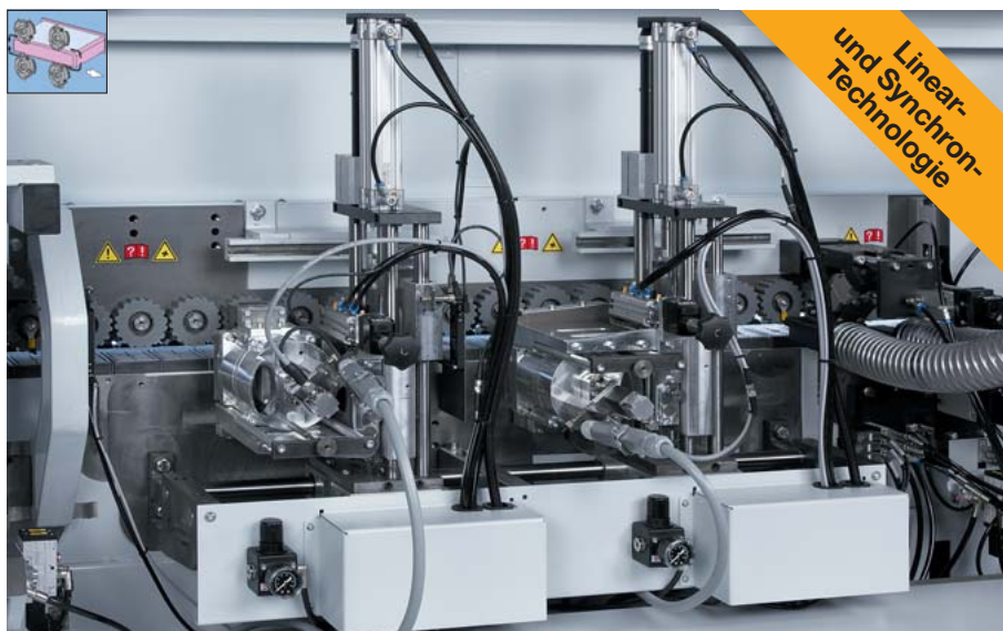
Multifunktions-Fräsaggregat (optional) Zum Bearbeiten der Kantenüberstände an der Werkstückober- und unterkante sowie zum Eckenkupieren der Vorder- und Hinterkante. Ausgerüstet mit automatischer Verstellung zwischen Dünn- und Dickkante. Werkstückdicke 60 mm.
