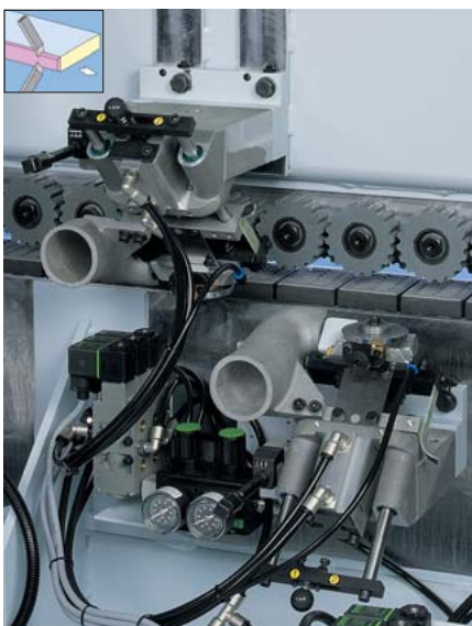
Profilziehklingenaggregat Aggregat zum Glätten von Radien oder Fasen. Ausgestattet mit Wechselköpfen für schnellen Profilwechsel.
