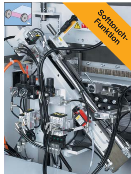
Kappaggregat Exakter Kappschnitt durch robustes Kappaggregat mit hochpräziser Linearführung und Werkstücklückenoptimierung für eine höhere Ausbringungsmenge in gleicher Bearbeitungszeit. Softtouch-Funktion für ein optimales Kappergebnis auch bei hohen Vorschubgeschwindigkeiten.
