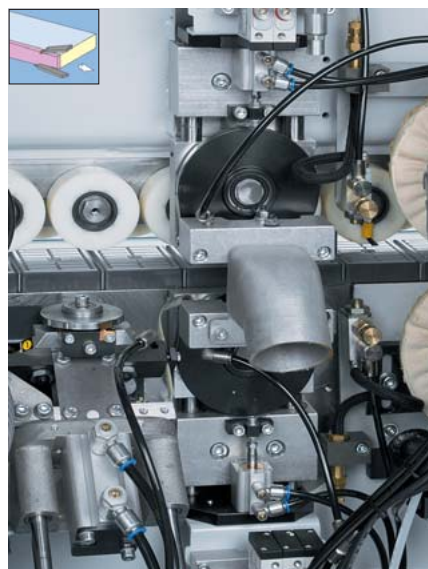
Leimfugenziehklingenaggregat (optional) Für das perfekte Finish und eine Materialabnahme bis zu 0,3 mm.
