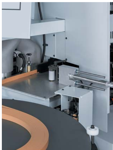
Einzugsvorrichtung (optional) Automatischer Kanteneinzug zum schnellen Kantenwechsel zwischen unterschiedlichster Rollenware.
