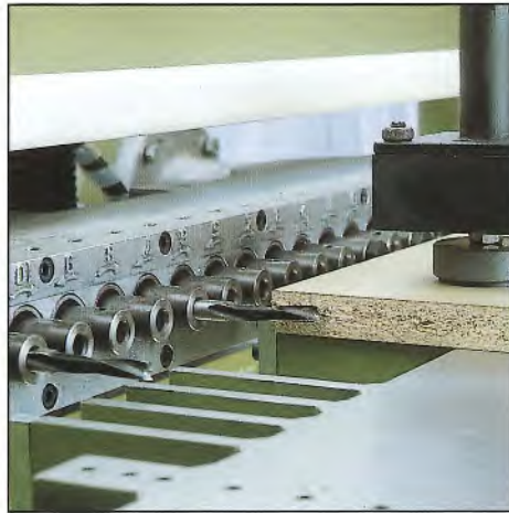
Automatischer Höhenausgleich beim Schwenken von Flächen- auf Stirnbohrungen.
