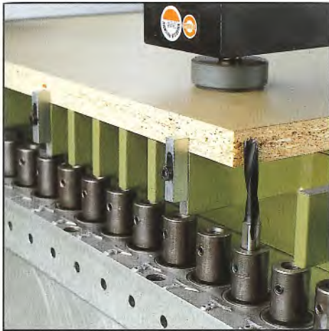
Automatischer Höhenausgleich beim Schwenken von Flächen- auf Stirnbohrungen.
