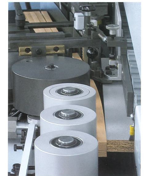
Druckzone (KDF 600er) Schwere Druckzone (bis 12 mm) für eine optimale Leimfugenqualität.
