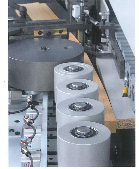
Druckzone (KDF 900er) Schwere Druckzone (bis 20 mm) für eine optimale Leimfugenqualität.
