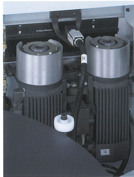
Fügefräsaggregat Perfekter Schnitt und hohe Standzeit durch Diamantwerkzeuge für eine optimale Leimfugenqualität.
