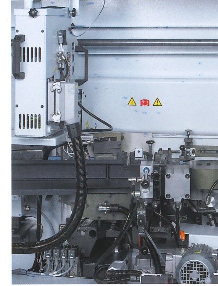
Magazin Rollen- und Fixlängenmagazin mit optischer Kantenüberwachung für sichere Materialzufuhr, ausgestattet mit Quickmelt Verleimteil.
